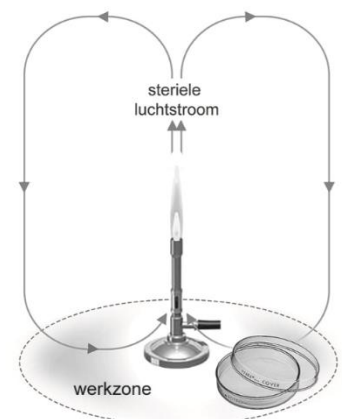
Figuur 6: Steriele luchtstroom met bunsenbrander
