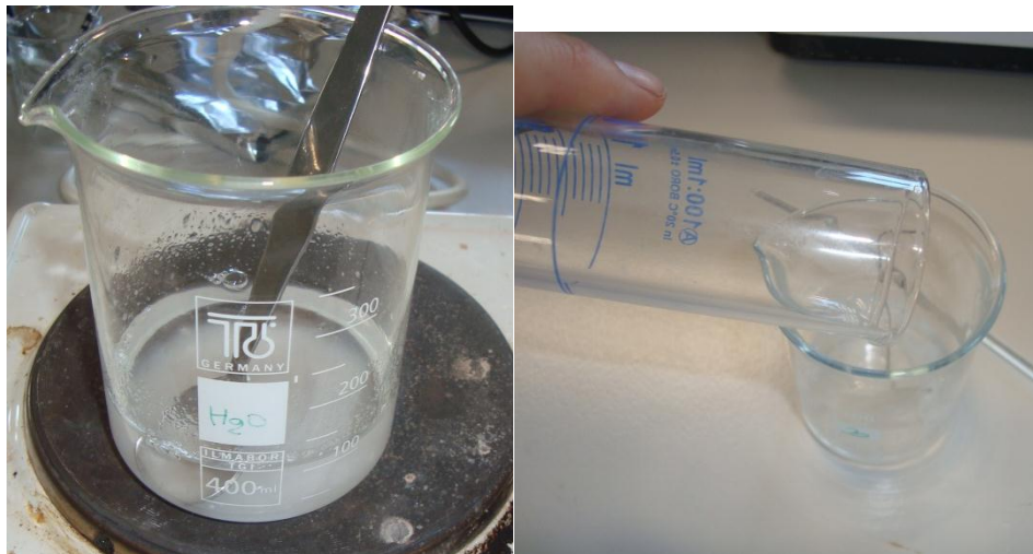
Verwarmen van polyvinylalcohol 10ml aceton toevoegen bij 10 ml polyvinylalcohol
